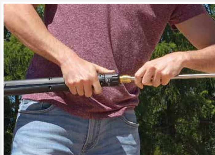
Рис. Исполнение с резьбовым соединением
